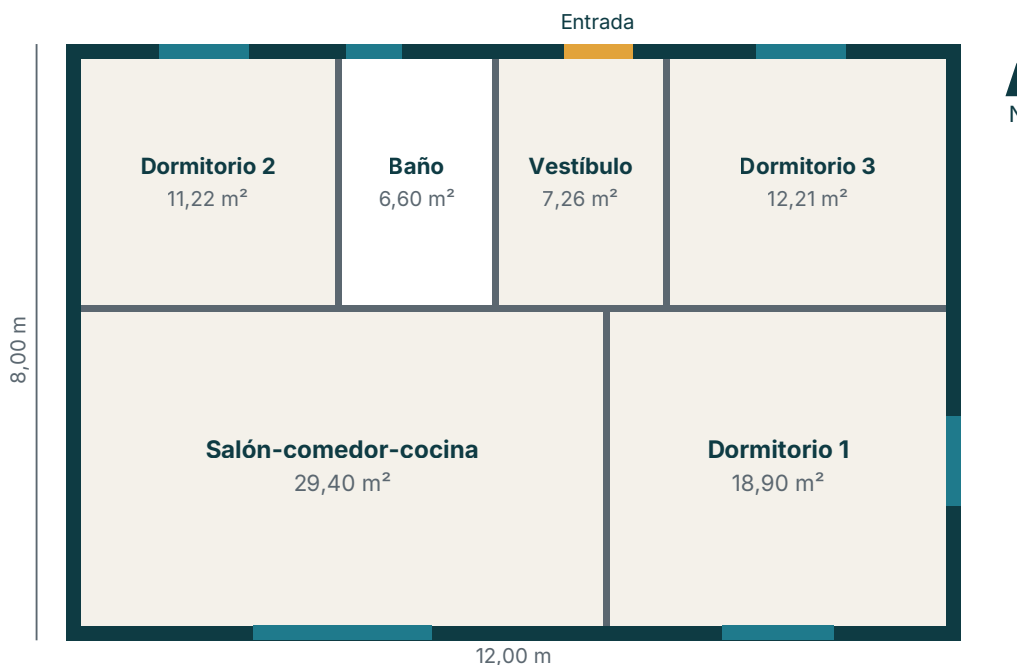
Figura 7.2 · Planta esquemática de la Vivienda modular Albufera con sus estancias y superficies de contorno (huecos de ventana en azul verdoso, entrada en ámbar).
