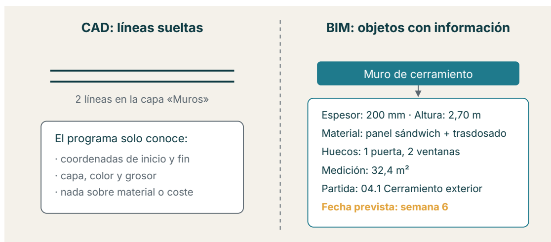
Figura 1.1 · El mismo muro representado en CAD tradicional y como objeto BIM con información asociada.
